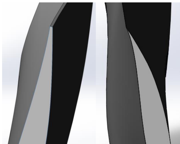
Figura 5 Pala con borde de salida plano de 1.5 mm y pala con borde de salida en punta Fuente: Elaboración propia
